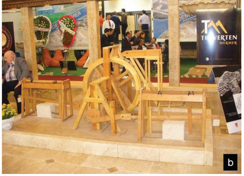
Şekil 6: a) Pamukkale’de kazı çalışmaları sırasında bir mezar odasında bulunmuş, üzerinde taş kesme makinası (katrak) kabartması işlenmiş traverten bloğu. b) Traverten blok üzerindeki kabartmanın ahşap rekonstrüksiyonu. Rekonstrüksiyon Kömürçüoğlu Mermer Şirketi tarafından yaptırılmıştır
