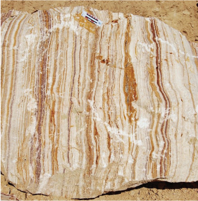
Şekil 5: Denizli Havzası’nın kuzeybatısında, Yenicekent yakınlarında, Büyük Menderes Vadisinin doğu kesiminden bir bantlı traverten (damar tipi traverten) bloğu.
